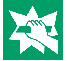
Notausgangsvorrichtung, die nach Zerschlagen einer Scheibe zu erreichen ist
